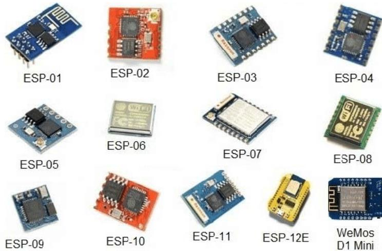
ESP8266 Node MCU는 ESP-12 모듈에 USB와 아두이노IDE환경 지원 등을 추가해서 아두이노의 한 종류처럼 개발된 모듈로서 IOT(Internet Of Things)환경에서의 기본형 프로세서로 많이 사용된다. 즉, IOT환경을 위해서는 WIFI 통신기능이 필수인데 기존의 아두이노에 WIFI장치를 부착하는 것보다 NodeMCU 하나를 사용하는 것이 편리하다.
