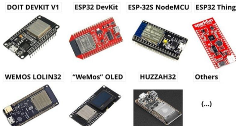
ESP32는 중국 Espressif Systems라는 회사에서 ESP8266이 인기를 얻고나서 후속작으로 내놓은 상위 기종으로 WIFI뿐만 아니라 Bluetooth 4.2도 기본으로 지원하고 처리속도도 빨라졌다. 무엇보다도 ESP8266에서 부족했던 범용 입출력 핀이 대폭 늘어나서 활용 범위가 커진 것이 장점이다. 특히 속도가 2배 정도 빨라졌고, GPIO가 17개에서 36개로 두 배이상으로 늘어났으며 Touch센서, 온도센서 기능들이 추가되었다.
